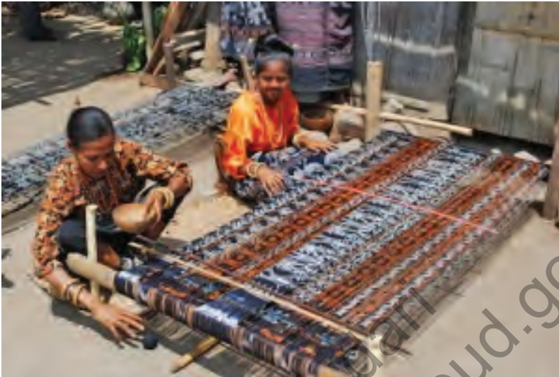
Gambar 1.34 Benang Lungsin yang sudah diwarnai dengan teknik ikat celup untuk tenun ikat Flores
