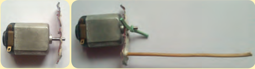
Gambar 2.26. Pemasangan tutup botol dan lidi pada Motor Listrik DC
